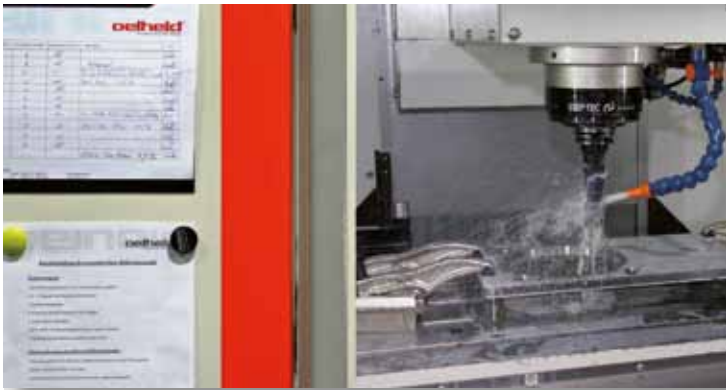
Bild 6: Versuchsreihe mit Kühlschmierstoffen von oelheld beim Fräsen auf einem Bearbeitungszentrum Mikron VCE 1000 Pro-X (GF AgieCharmilles)
